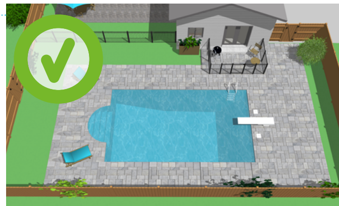
Exemple d'une enceinte de piscine située à plus de 1 m d'un mur de soutènement.
