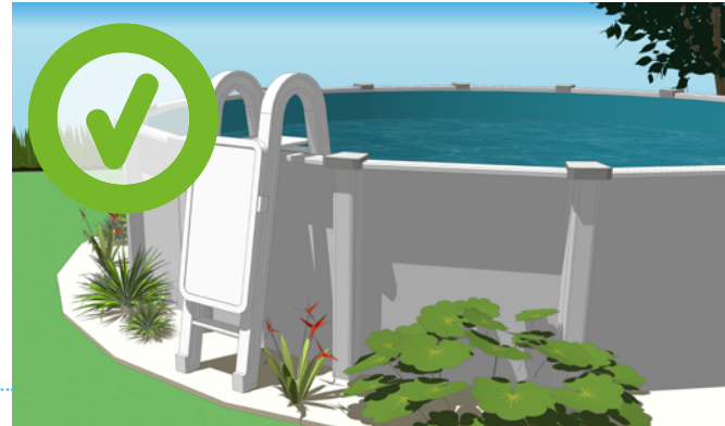
Exemple d'échelle munie d'une portière de sécurité.
