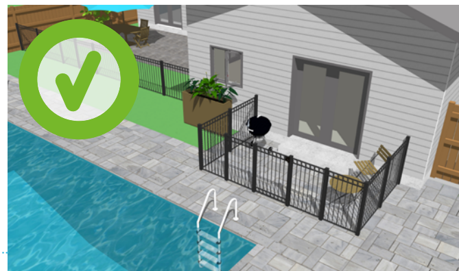
Porte-patio entourée d'une clôture afin d'empêcher l'accès direct à l'intérieur de l'enceinte de la piscine.
