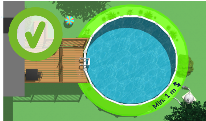
Les appareils de fonctionnement de la piscine sont situés à plus de 1 m de celle-ci. De plus, il n'y a aucun équipement fixe susceptible d'être utilisé pour grimper par-dessus la paroi à moins de 1 m de celle-ci.
